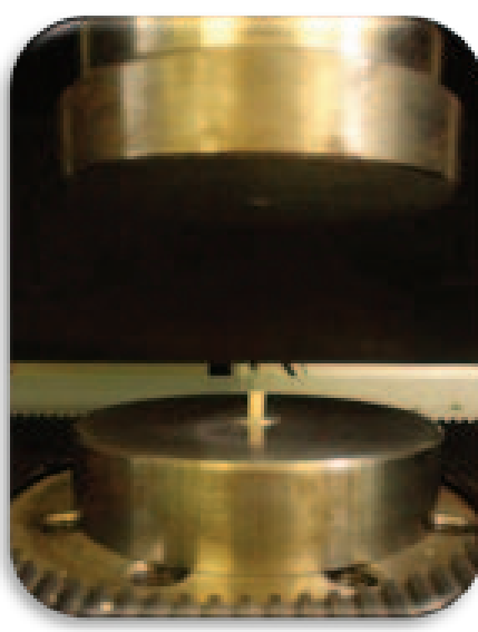
Figura 2) Amostra a ser submetida a uma força axial compressiva
